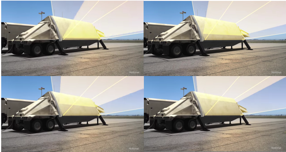
그림 4 Raytheon사의 탄도미사일방어체계 영상 중 AN/TPY-2 레이더 조사 모습 (전자파 조사는 좌상 그림부터 시계방향으로 이루어짐)
